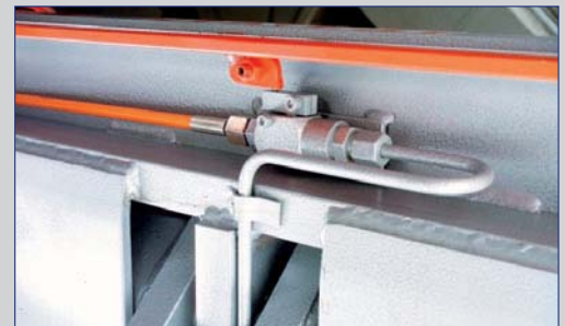
Hydraulisches Sicherheitsventil unter der Hubtischplattform
